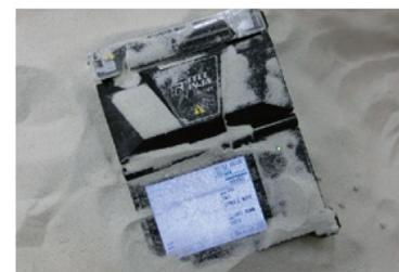
Test Antipolvere equivalente alla verifica IP5X \*2
